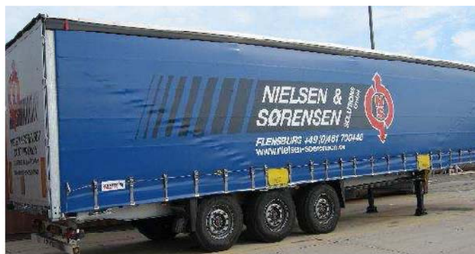
Figur 2: Semihenger med støttebein. Gripearmslommer markert med gult.
