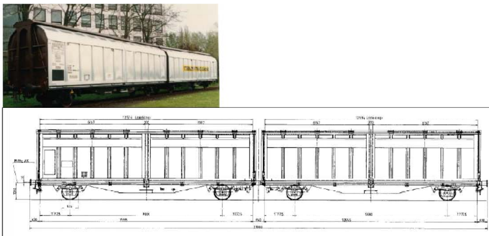
Figur 4: Typisk vognlastvogn. (Her "Hirr's - 1/273", lengde 27 m. Lastelengde 2x 12,534m. Egenvekt 31 tonn, lastekapasitet 62 tonn. Lasterom 2x103 m 3 )
