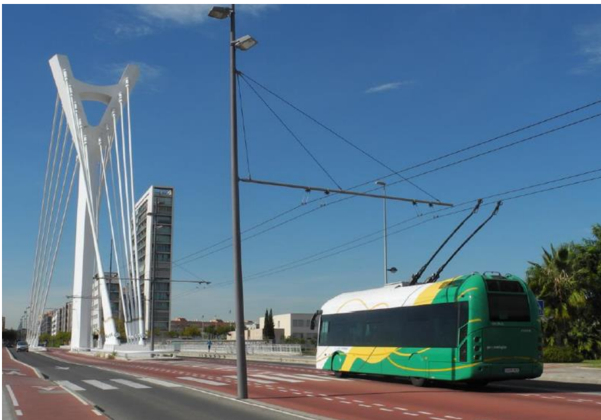
Figur 3-4. Trolleybuss er en variant av Superbuss. Bussvei2020-prosjektet i Stavangerregionen skal baseres på trolleybuss. Kilde Rogaland fylkeskommune
