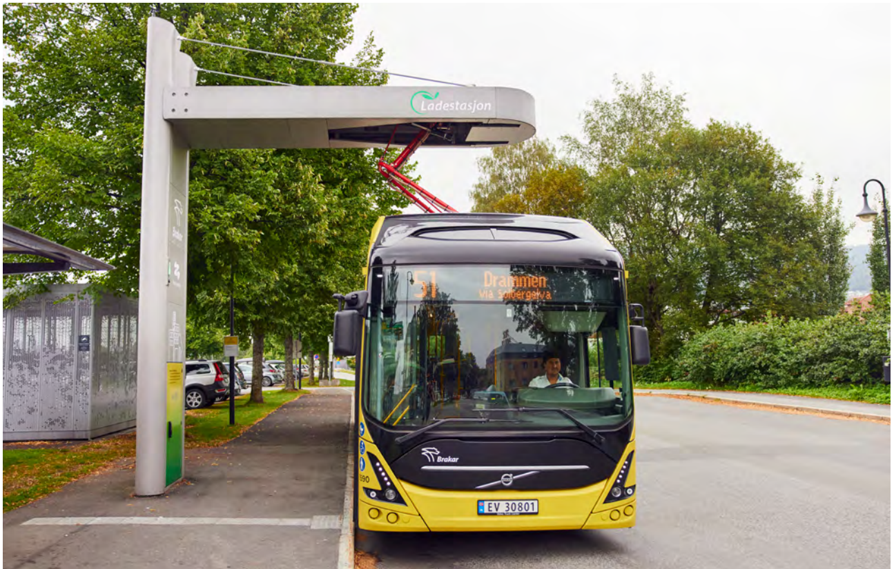
Hurtigladdestasjon for elbuss er også etablert ved Mjøndalen stasjon. Elbusser utgjør nå over halvparten av bybussene i Drammen.
