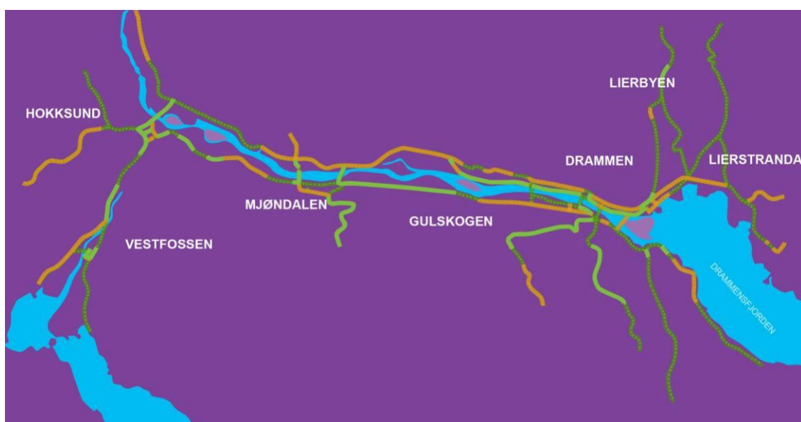
Figur 3-6 Heltrukne lysegrønne linjer viser prioriterte strekninger fra Handlingsprogram 2018-23. Mørkegrønne linjer viser deler av regionalt sykkelvegnett som har eksisterende og eldre sykkelinfrastruktur (sees på som del av sykkelveginspeksjoner). Oransje strekninger viser manglende sykkelinfrastruktur og har sykling i blandet trafikk innenfor regionalt sykkelvegnett.
